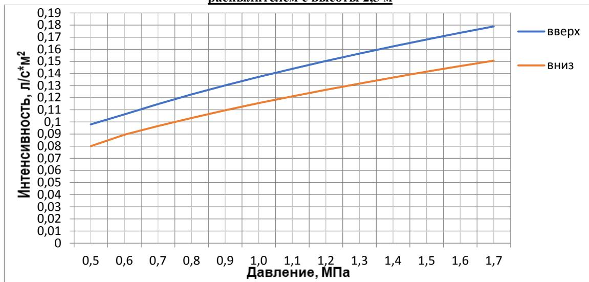
**График зависимости интенсивности орошения от давления на площади 9 м<sup>2</sup>, защищаемой группой распылителей (два и более) с высоты 2,5 м**
