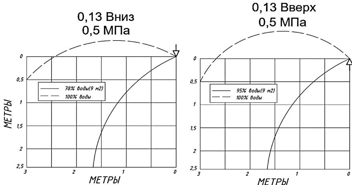
**График зависимости интенсивности орошения от давления на площади 9 м<sup>2</sup>, защищаемой одним распылителем с высоты 2,5 м**
